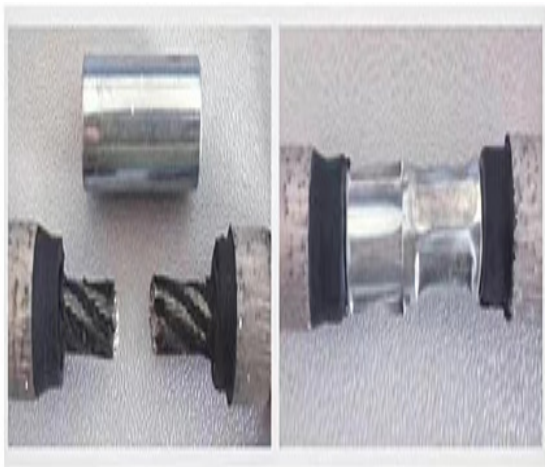
图 2 串珠接头扣压
