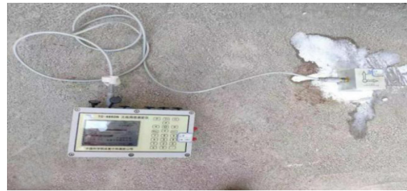
图 1 为现场爆破测振操作实景图
