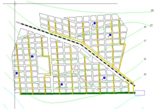
图 1 某城市管网概化布置
