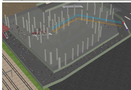
图 Pathfinder & Revit 结合进行人流量分析及人员疏散路径模拟应用
