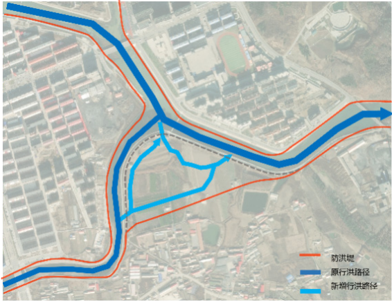
图 3 调整用地后，防洪堤和行洪路径
