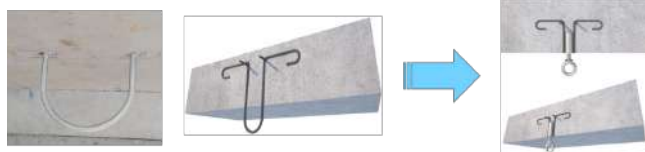
图 8 预埋吊钩节点优化
