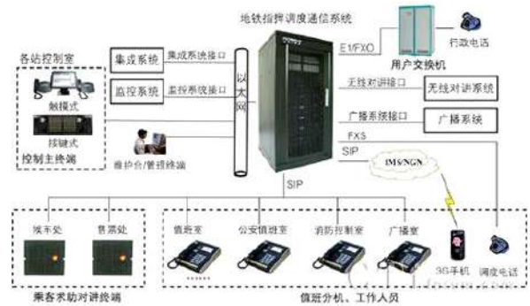
图1 地铁指挥调度通信系统
