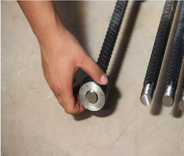
图4 通规、止规检验螺纹孔
