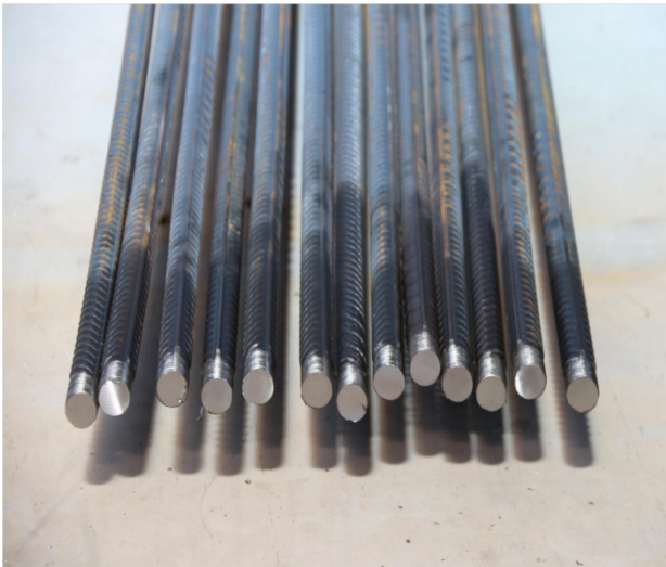
图5 锯切一体套丝机加工钢筋质量效果
