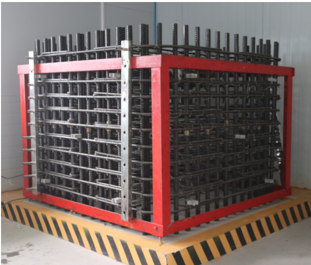
图6 墩柱钢筋加工胎架
