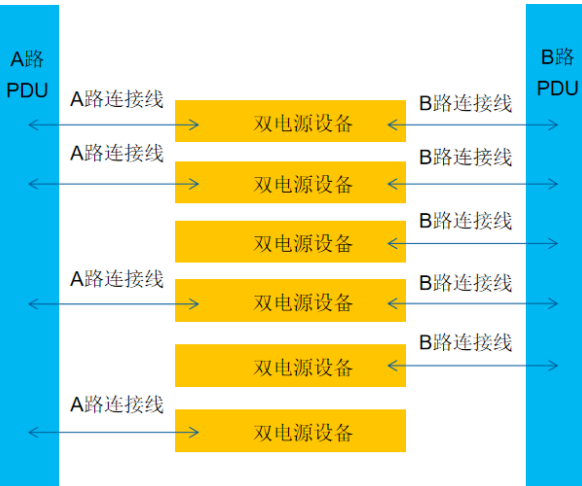
图 3 漏配线，部分双电源设备只接了一路，未实现双路供电
