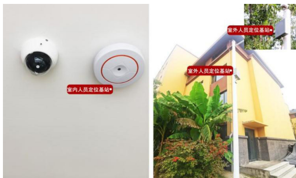
图 2 室内外人员定位基站图
