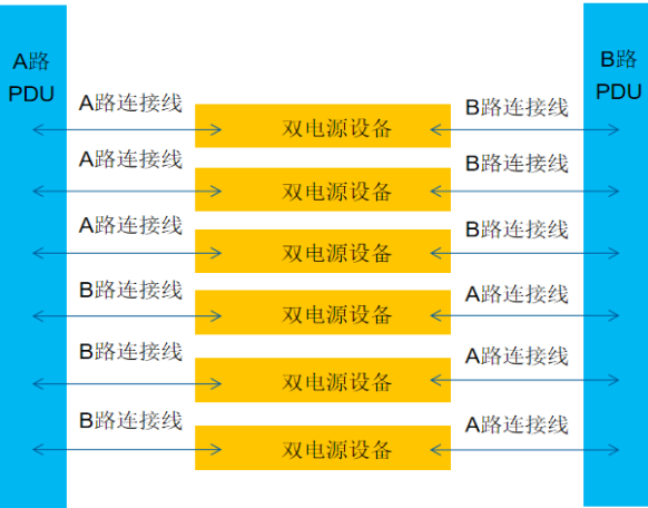
图 2 错配线，部分 A、B 路接反示意图
