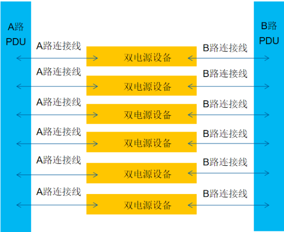
图 1 双电源设备柜内布线示意图
