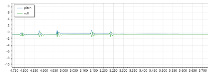
图 3 连续自由行走 Pitch 与 Roll 波形显示
