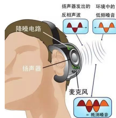
图 1 主动降噪耳机的图解原理
