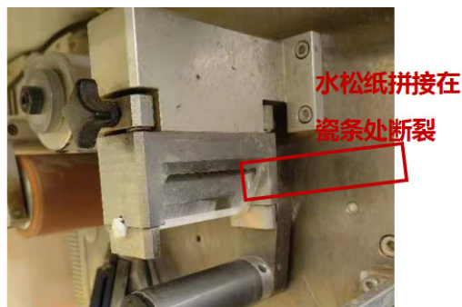
图 1 拼接水松纸断裂
