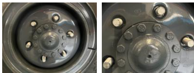
图7 调整轮胎位置,确保孔轴同心
