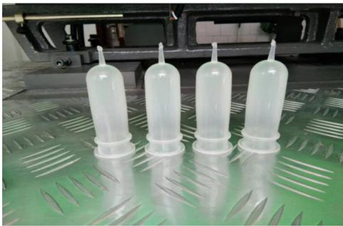
图 1 采用最佳工艺条件得到的瓶胚
