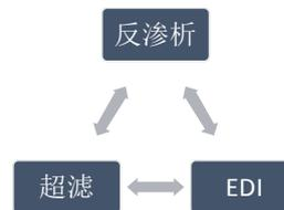
图 1 全膜法污水处理工艺的应用要点
