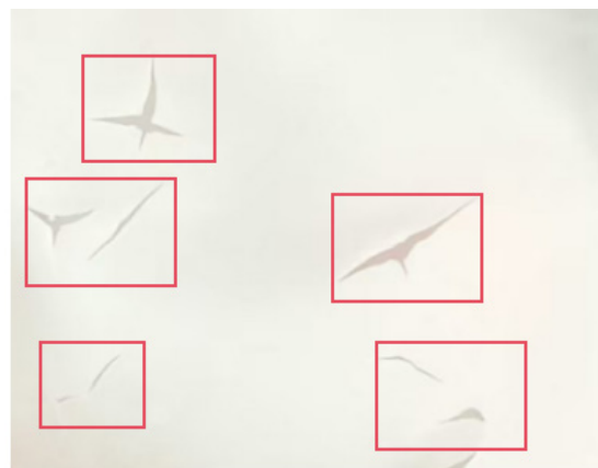
图3 预硫化时间6h, 预硫化温度70°C时完成浸胶、固化后胶膜状态
