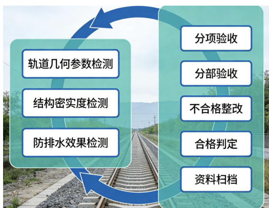
图2 高速铁路隧道无砟轨道质量检测与验收流程示意图
