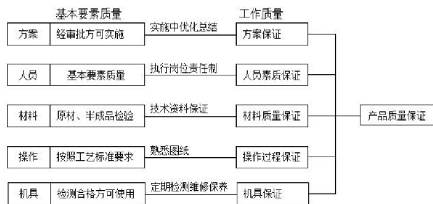
图3 电气安装施工质量保证流程
