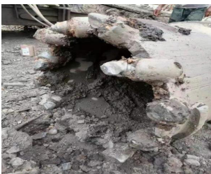
图11 旋挖磨损的筒钻钻头 图12 冲击钻使用后的钻头
