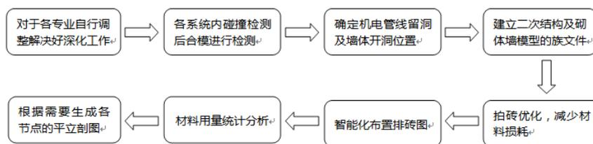
图 1 BIM 砌体工程深化设计流程
