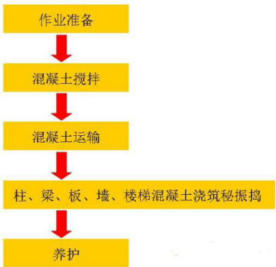
图2 混凝土浇筑流程
