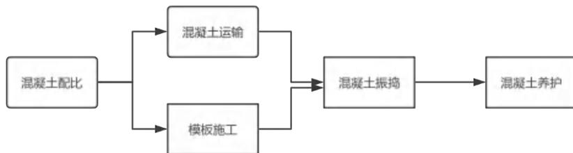
图2 房建建筑工程混凝土浇筑技术要点
