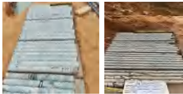
图3 抽芯检测桩身完整性及持力层条件
