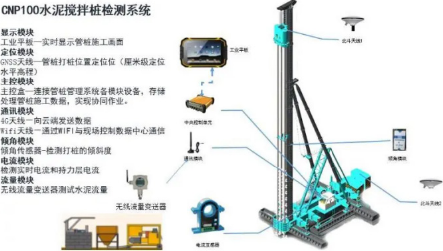
图 1 水泥搅拌桩数字施工系统
