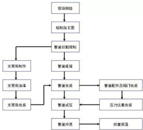
图1 暖通水系统管道安装流程图
