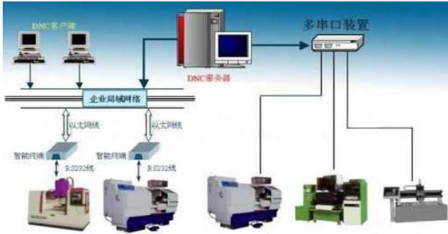
图 3 数控机床的局域网连接
