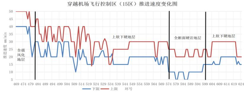
图 1 T 机区间下穿飞行区控制区（15 区）推进速度变化曲线图
