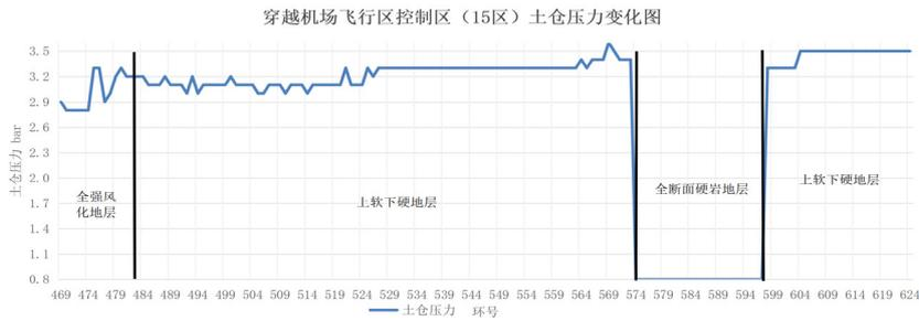
图 2 T 机区间下穿机场飞行区土仓压力变化曲线图
