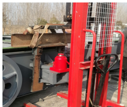
图2 锁定装置销子拆除专用工具
