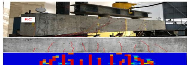
图2 混凝土损伤对比图
