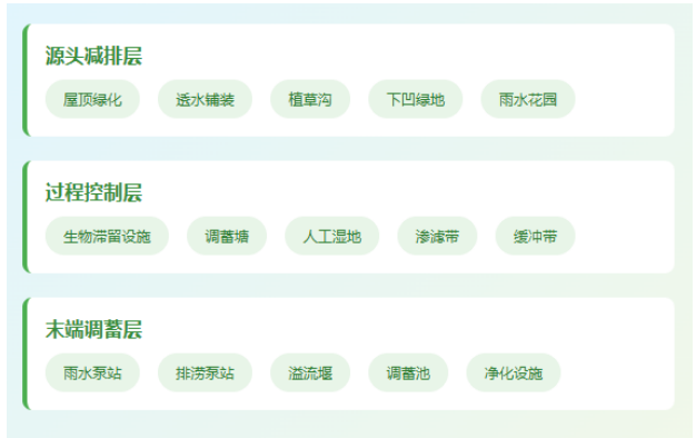
图 1 海绵城市多层次分散式雨水系统技术框架
