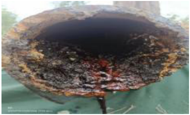
图 2 输油管道结垢腐蚀情况
