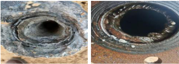
图4 明10号站201注水线除垢效果
