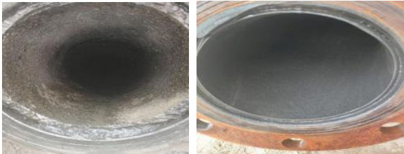
图6 输油管道涂膜后效果
