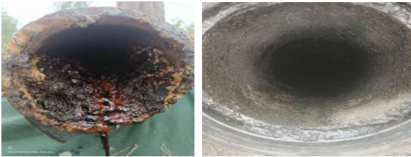
图5 输油管道除垢效果
