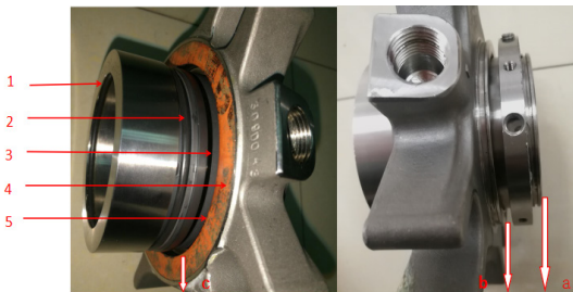
图1 机封密封结构与密封面示意图
