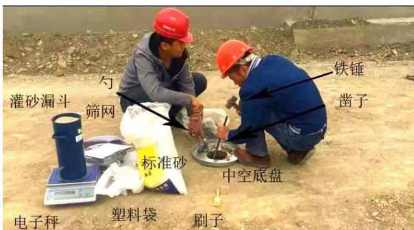
图 1 路基压实度检测 (灌沙法)
