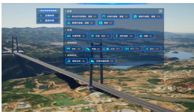
图 2.1 特大跨径桥梁数字孪生监测界面
