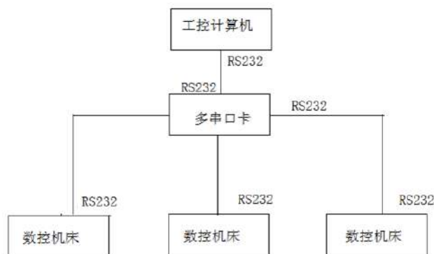
图 1 采用多串口卡通信结构
