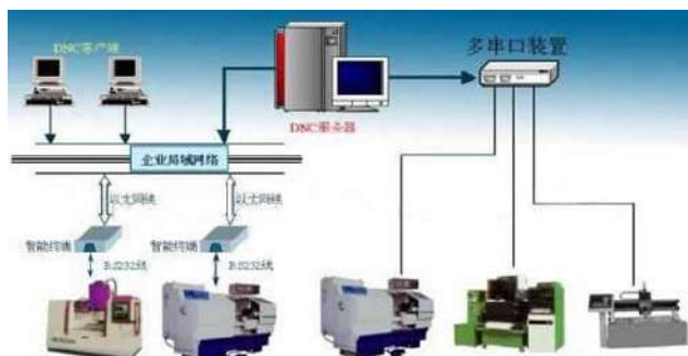
图3 数控机床的局域网连接
