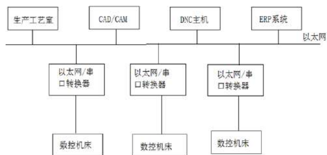
图 2 基于以太网的数控网络通信结构
