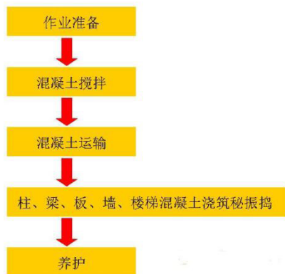
图 2 混凝土浇筑流程
