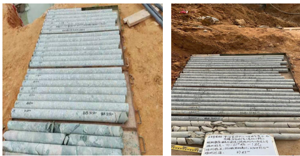
图3 抽芯检测桩身完整性及持力层条件
