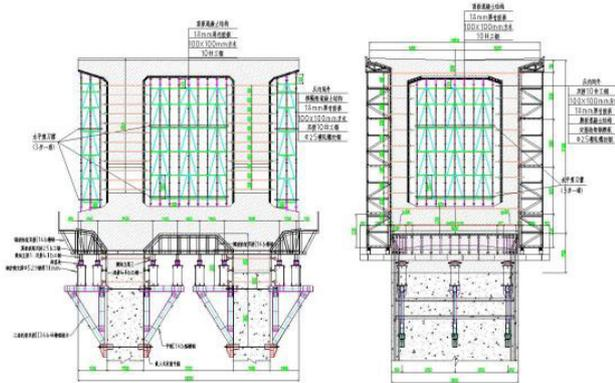
图1 0#块及托架设计图
