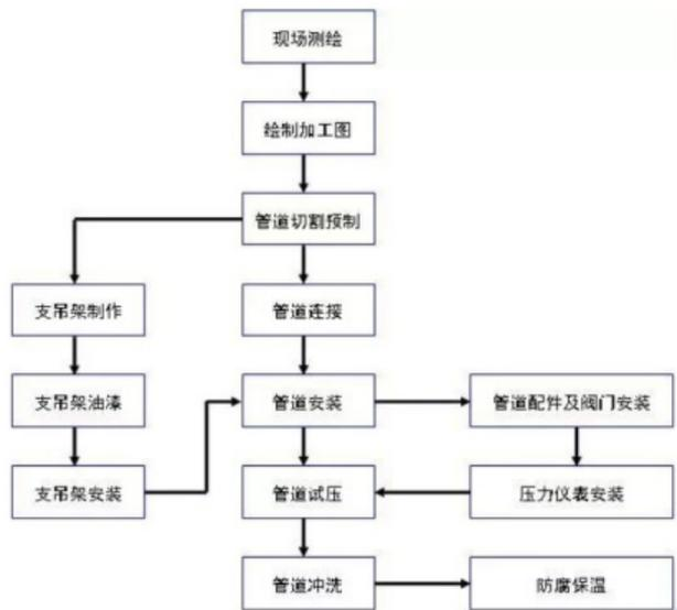
图1 暖通水系统管道安装流程图
