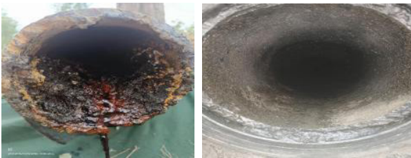
图5 输油管道除垢效果
