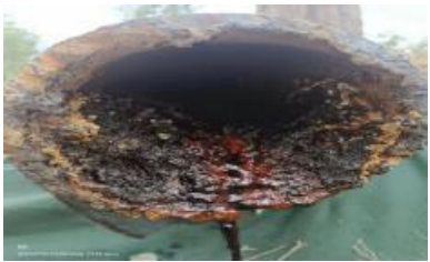
图 2 输油管道结垢腐蚀情况
