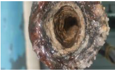
图 1 注水管道结垢腐蚀情况
