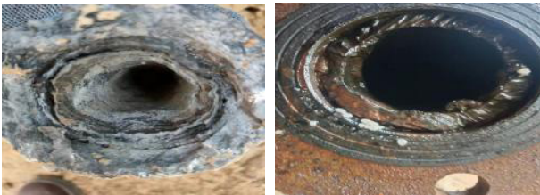
图4 明10号站201注水线除垢效果
