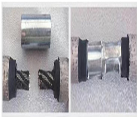
图2 串珠接头扣压
