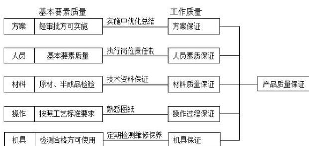
图3 电气安装施工质量保障流程
