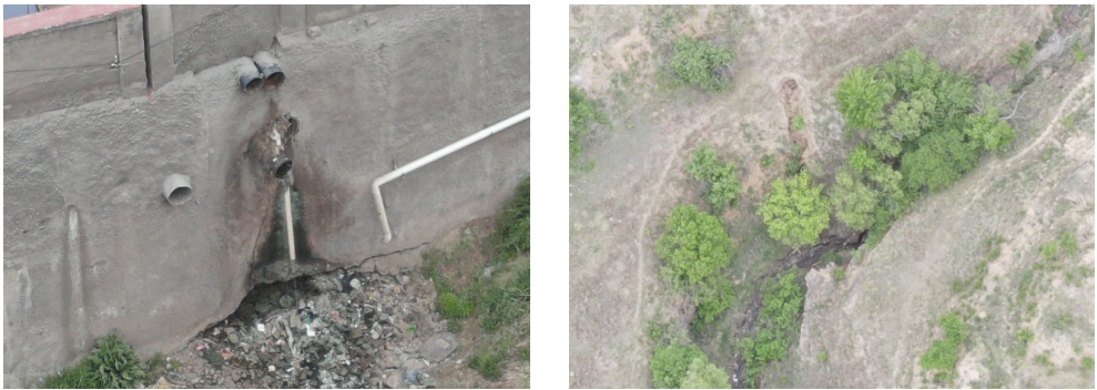
图 1 无人机遥感解译识别的入河排污口和可疑区域（被林木遮挡）
