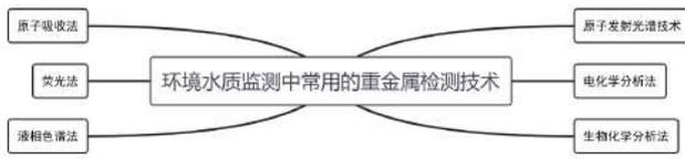
图1 环境水质检测中常用的重金属检测技术
