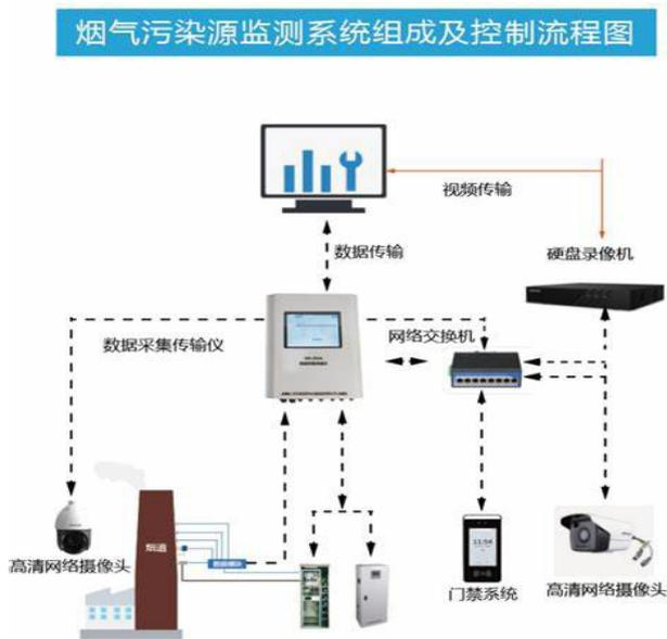
图2 烟气污染源自动监测的构成
