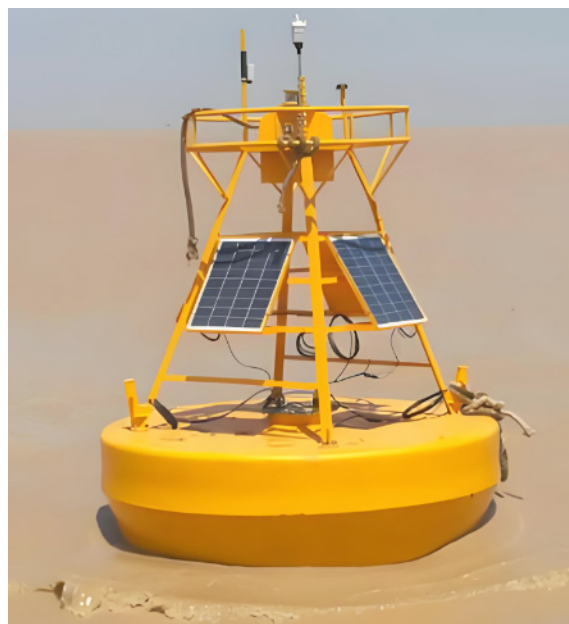
图 2 海洋营养盐检测工作中所用的浮标实拍图
