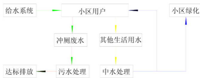
图2：小区中水回用管道流程
