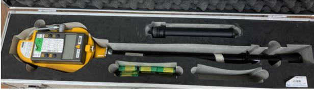
图2 长杆式辐射剂量监测仪
