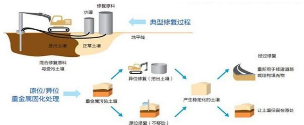
图1 土壤固化稳定修复技术
