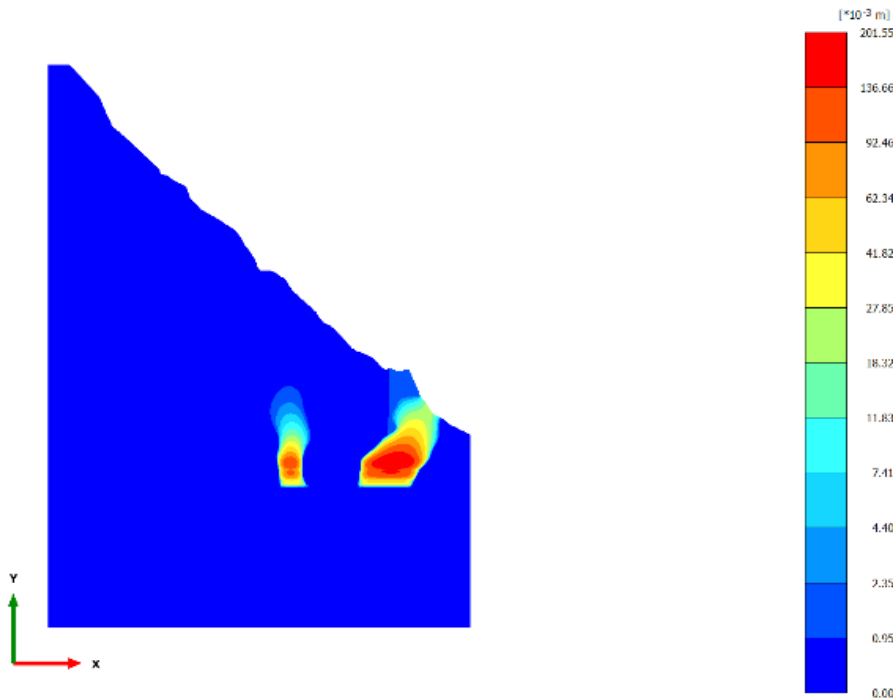
图 4 开采 1-5 中段引起模型竖直变形
