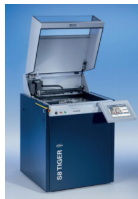
图 1 德国布鲁克 AXS 的 S8S8 TIGER 射线荧光光谱仪实拍图
